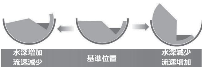
図-3 隔壁の回転により水深と流速を調整
