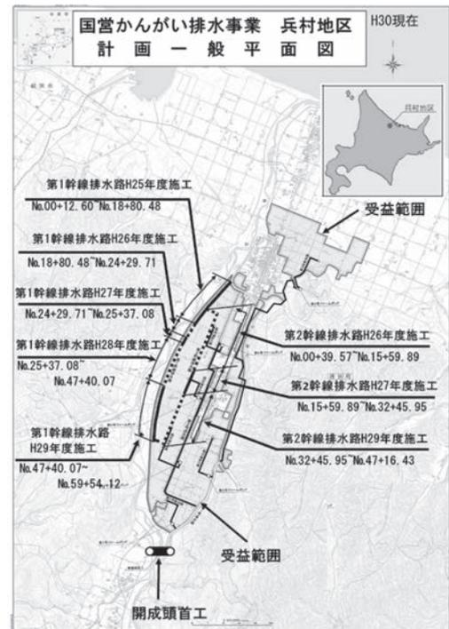
図-1 工事施工進捗状況
