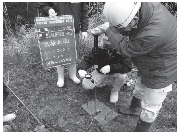
写真-3 ベーンコーンせん断試験状況
