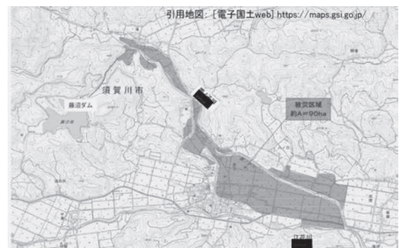
図-1 決壊による下流域の被災範囲
