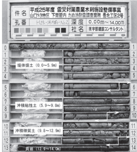
写真-1 H25-河内前-No.2のコア写真
