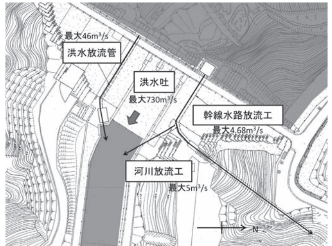
図-3 安濃ダムの放流ゲート施設(現況)
