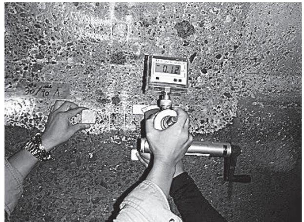
写真-3 付着強度測定状況
