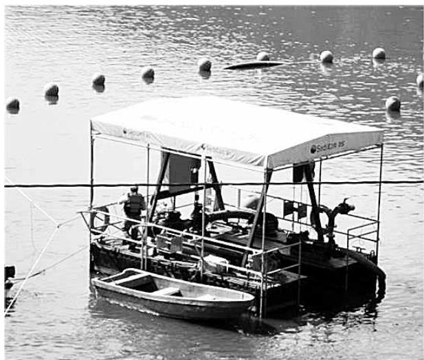
図-4 稼働中の浚渫機の (左) 浮台, および (右) 引出管
