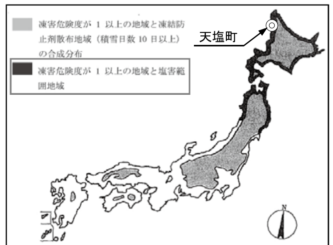
図-4 塩害と凍害による複合劣化の可能性がある地域 4)
