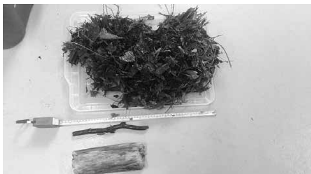
写真-3 水車内から除去されたゴミ
