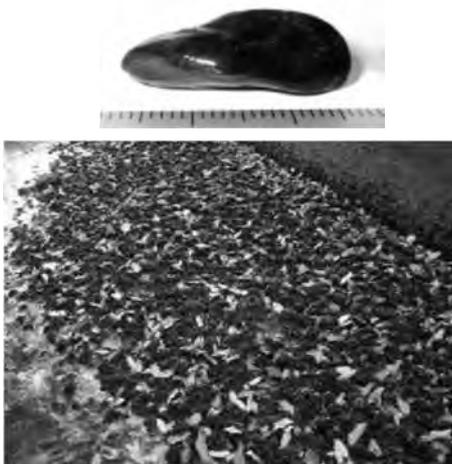
また、上流側でカワヒバリガイの大量<sup>へいし</sup>斃死が発生し、死貝により末端水路の給水栓やストレーナーが閉塞されている。調整水槽の壁面では、コンクリートの表面にできたへこみ、ひび割れ、隅の部分にカワヒバリガイが固着し、暗く湿潤なスクリーン内では、カワヒバリガイが高密度で固着している。
