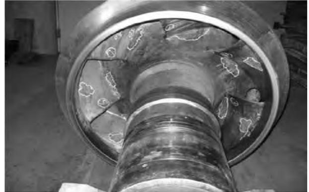
写真-2 インペラ（水車）の壊食状況（全景）
