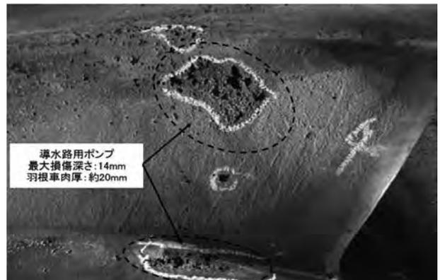
写真-3 インペラ（水車）の壊食状況（拡大）
