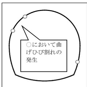
図-5 代表トンネル（Bトンネル）におけるレベル2地震動の静的解析の結果
