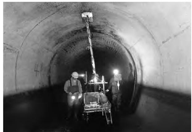
写真-4 トンネルのレーダー調査状況
