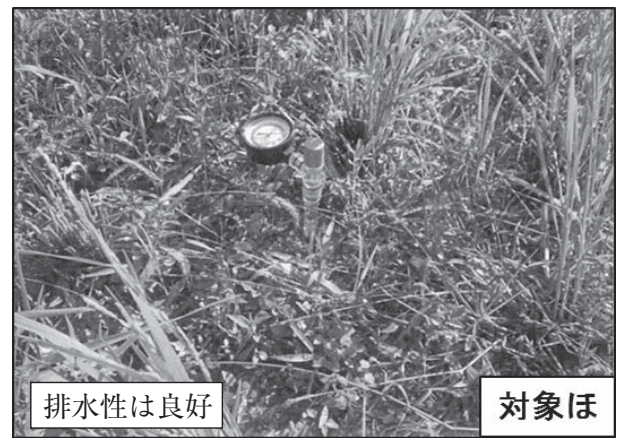
写真-7 講武地区の補助暗渠整備前の湛水試験状況(1日後)
