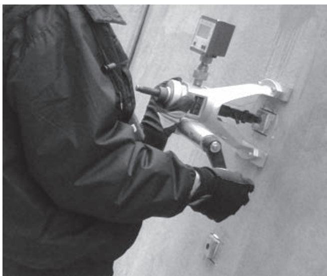
写真－６ 表面被覆材の付着強度試験
