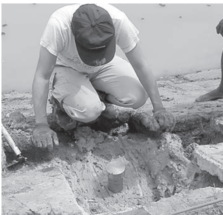
写真-8 現場密度試験
