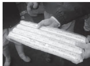
写真-5 無機系セメントモルタルカプセル
