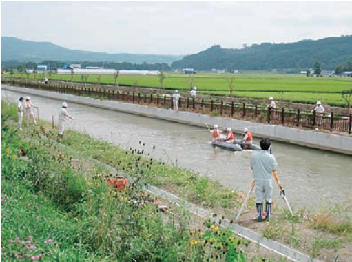
①水路底のレベル測量概況
