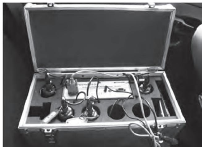
写真-2 相関式漏水探査機 センサー
