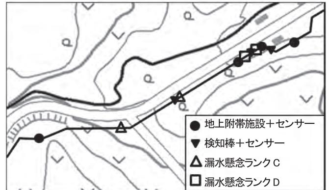
図-8 振動測定法のセンサー設置位置と漏水懸念箇所
