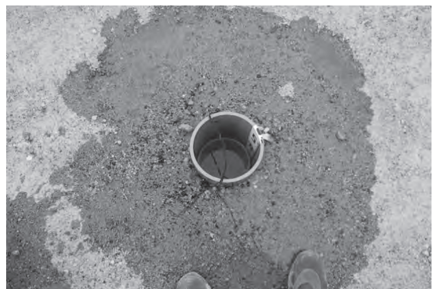
写真-6 RC材の浸水試験状況
