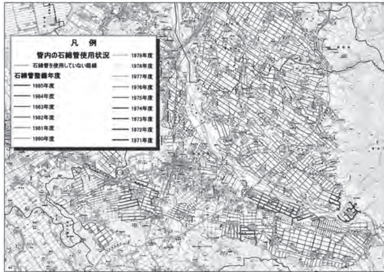
図-12 石綿管の使用状況と造成年度
