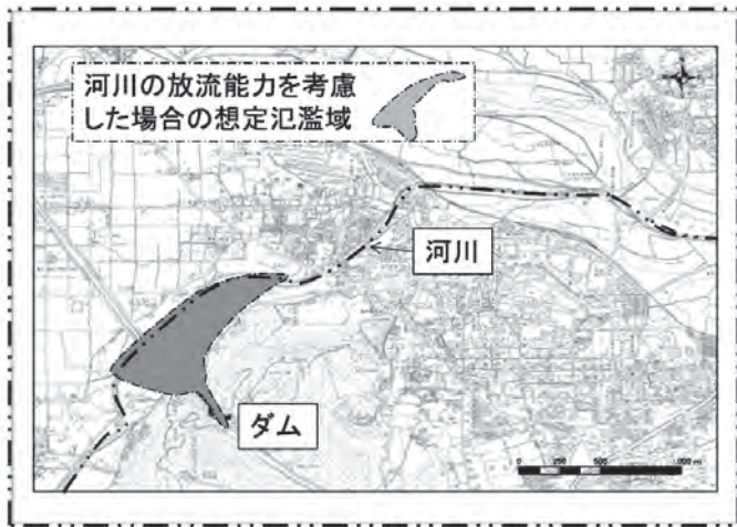
図-15 地震時に決壊した場合の氾濫想定域 (河川の放流能力を考慮した場合)
