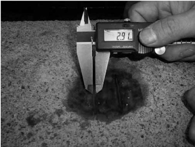
写真-3 PC鋼線・中性化確認状況
