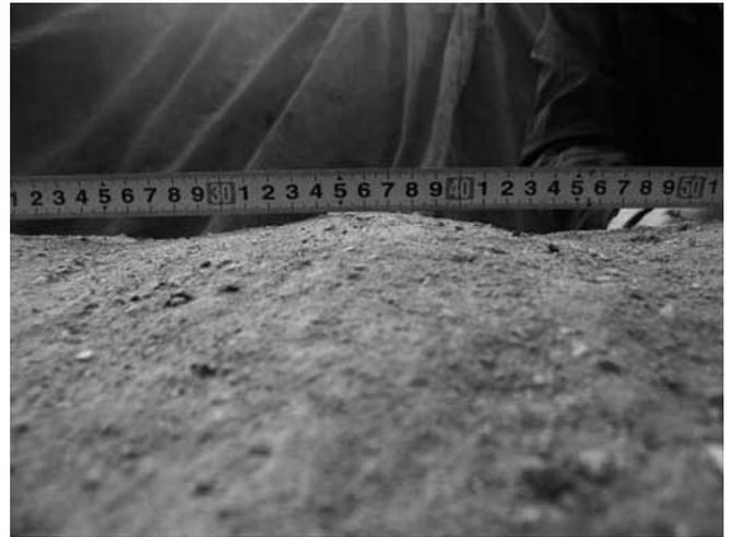
写真-4 カバーコート表面確認状況
