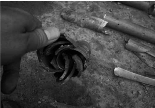
写真-4 共下がりに伴う保孔管(VP)の破損状況
