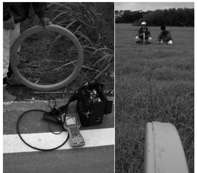
図-1 電磁探査機器（左）・測定状況（右）
