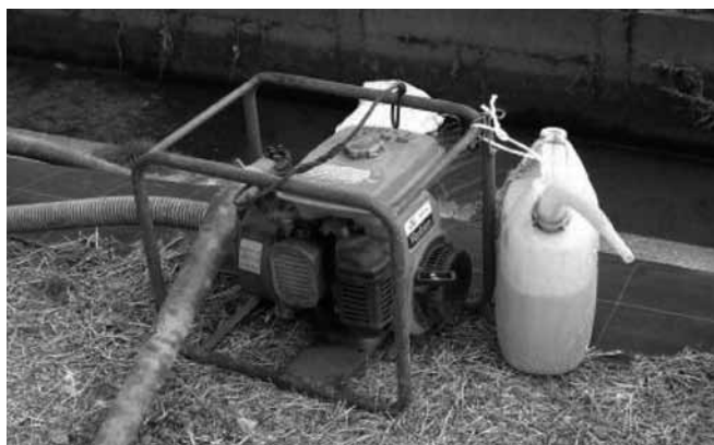
写真-4 ポンプアップによる用水供給
