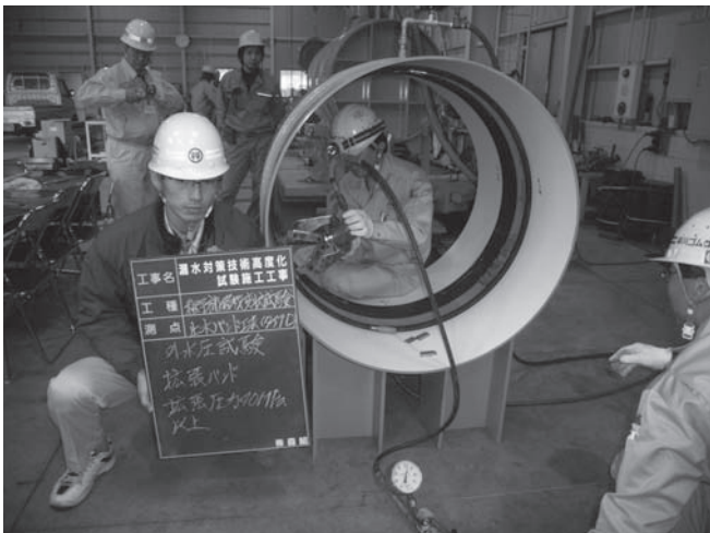
写真-6 外圧試験状況
