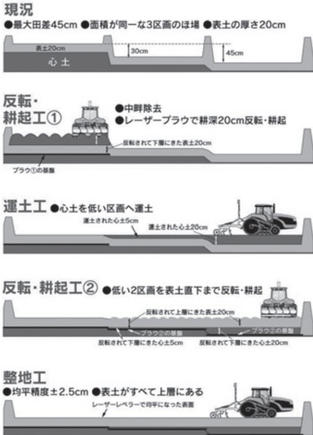
図-1 作業フロー (出典：スガノ農機資料より抜粋)
