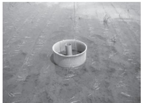
写真-4 地下水水位観測孔
