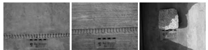
(a)鉄筋溝仕上げ (b)鉄筋溝+ホウキ目仕上げ (c)石埋め込み仕上げ
