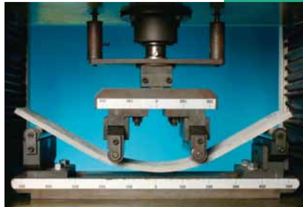
④ HPFRCCの優れた曲げ変形性能
