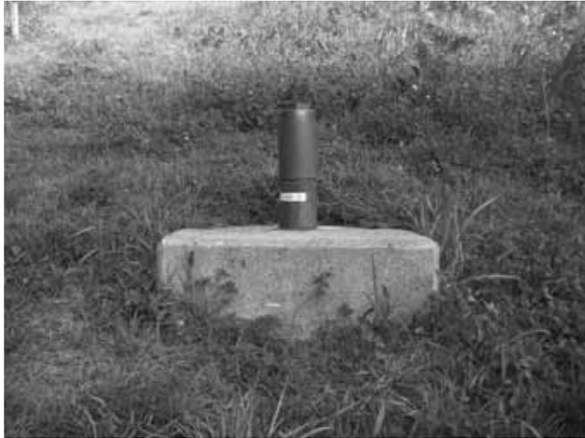
写真-2 地下水位観測孔
