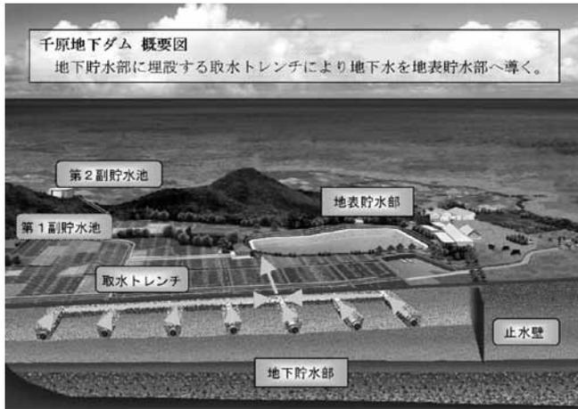
図-2 千原地下ダム概要図
