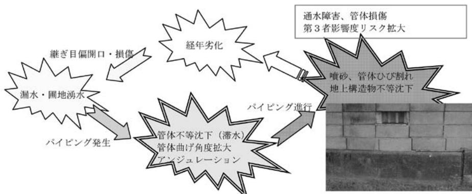
図-5 サイホン・パイプラインの変状機構
