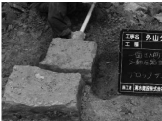
写真-7 石膏で固めたサンプリング試料
