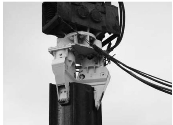
写真-3 ハット形鋼矢板専用チャック
