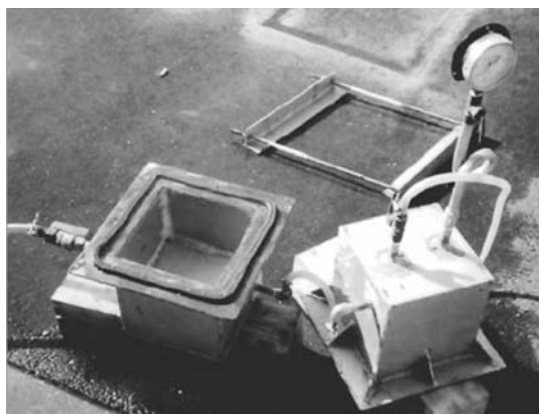
写真-3 止水試験装置
