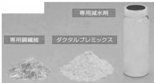
写真-1 超高強度繊維補強コンクリートパネル材料
