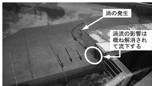
写真-4 左岸導流壁上流部の渦流 (設計洪水量 Q=268\text{m}^3/\text{s} 流下時)
