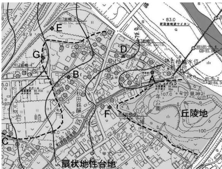
図-7 地下水コンター（工事前現況）と地質区分
