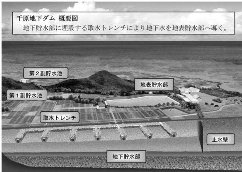
図-2 千原地下ダム模式図
