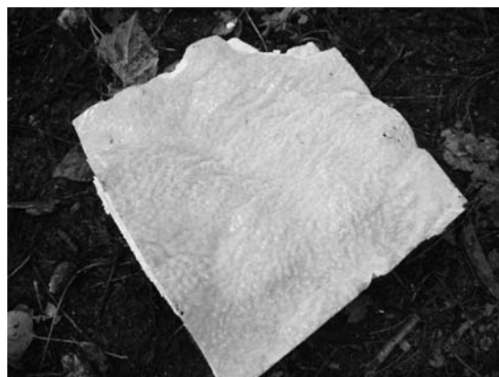
写真-8 発泡ウレタンの供試体
