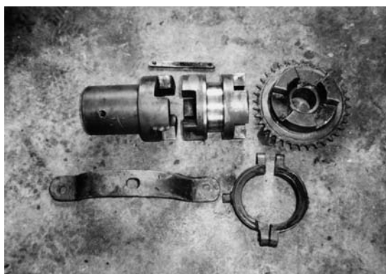
写真-3 クラッチギア摩耗による交換
