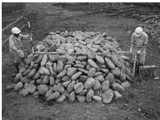
写真-10 玉石計測状況（控長30cm以上）
