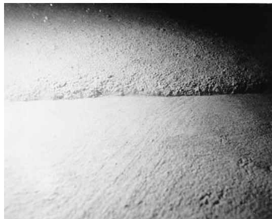
写真-12 水中コンクリートの流動状況
