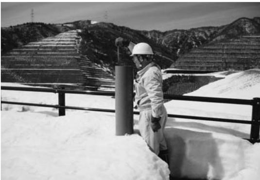
iv) 抜き取った塩ビパイプ (φ200mm) の重量を測定する。
