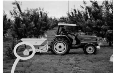
写真-1 疎水材充填機
