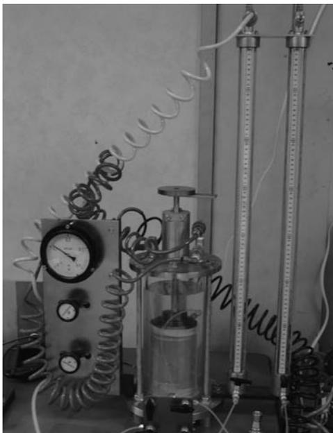
写真-8 三軸透水試験機の例 (F-TP75Mk.II型)
