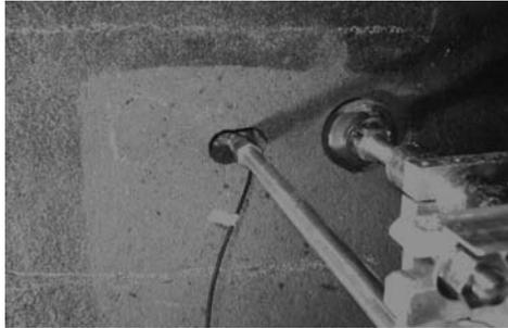
写真-6 螺旋状PC鋼線探査
