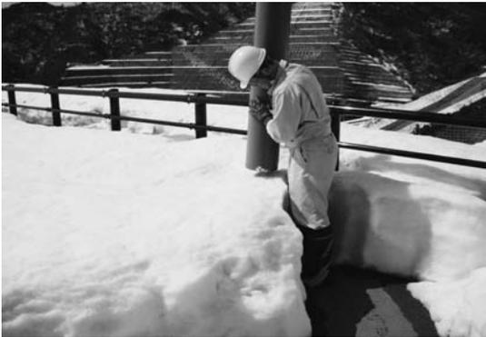
iii) ii) 周りの雪を排除し、雪の入った塩ビパイプ (φ200mm) を抜き取る。
