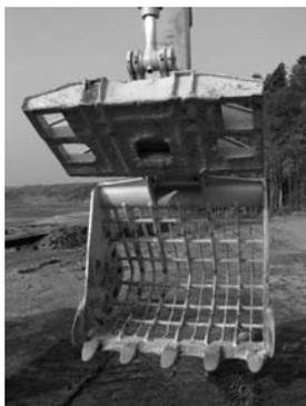
写真-4 解砕バケット (スケルトンバケット+押土板)
