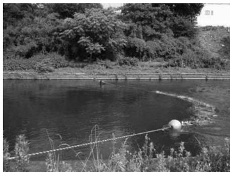
写真-8 救命ロープのたわみ状況（たわみ2.5m）
