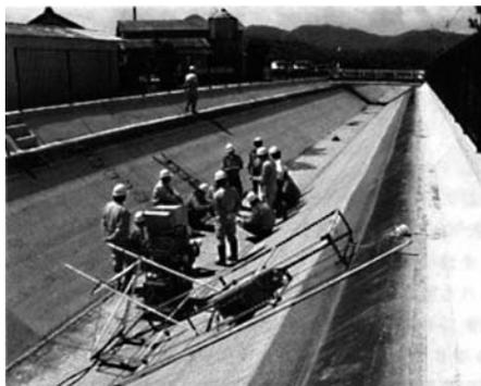
写真-11 地下レーダーによる測定状況
