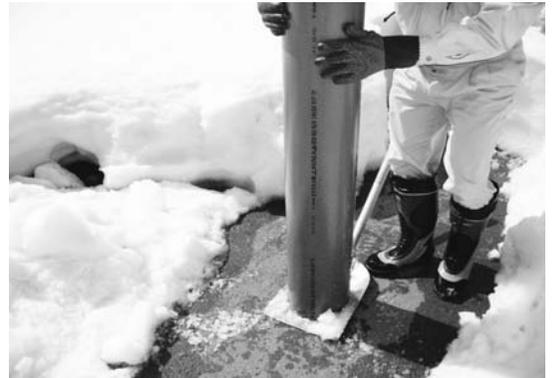
ii) 塩ビパイプ (φ200mm) 中の雪の深さを計測する。
