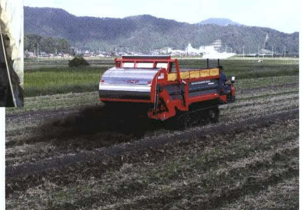
マニースプレッターによる散布状況 標準で10aあたり1.0tを散布
