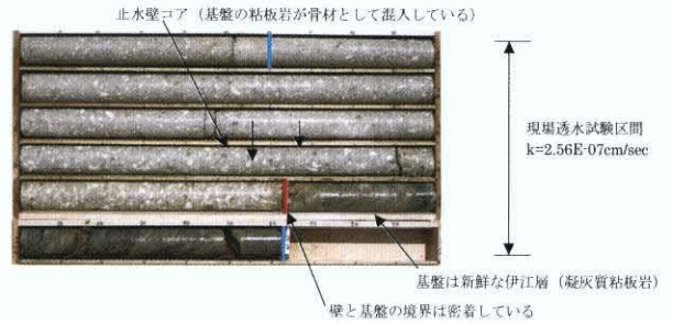
チェック孔コア写真 (CH-75:GL-56.0~-61.6m)
