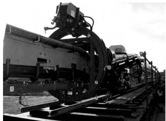
写真-5 後方設備 (プレミックスファイバーモルタル吹付ロボット)
