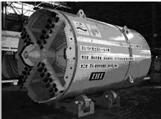
写真-1 シールドマシン
