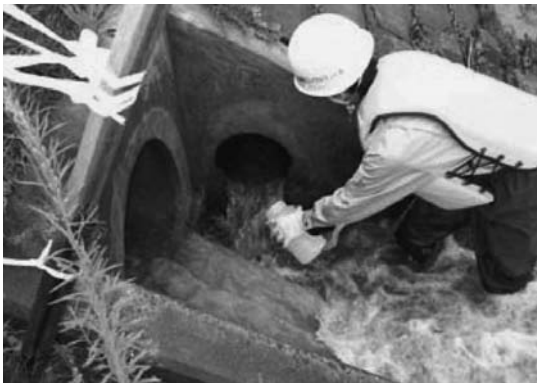
写真-4 暗渠出口水採水
