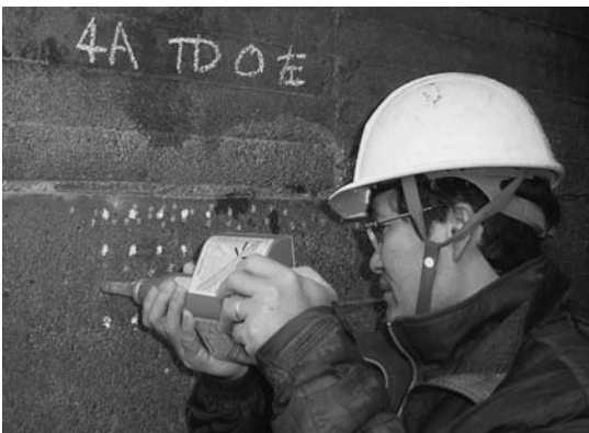
写真-9 シュミットハンマーによる調査
