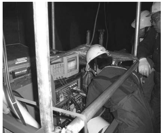
写真-13 レーザーによる連続画像計測
