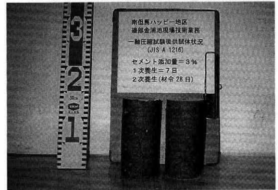
写真-2 一軸圧縮試験後供試体状況写真 セメント添加量 3%材
