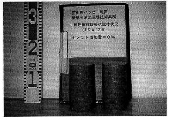
写真-1 一軸圧縮試験後供試体状況写真 単独材
