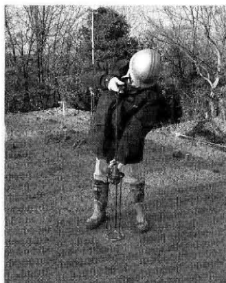
写真-7 球体落下試験
