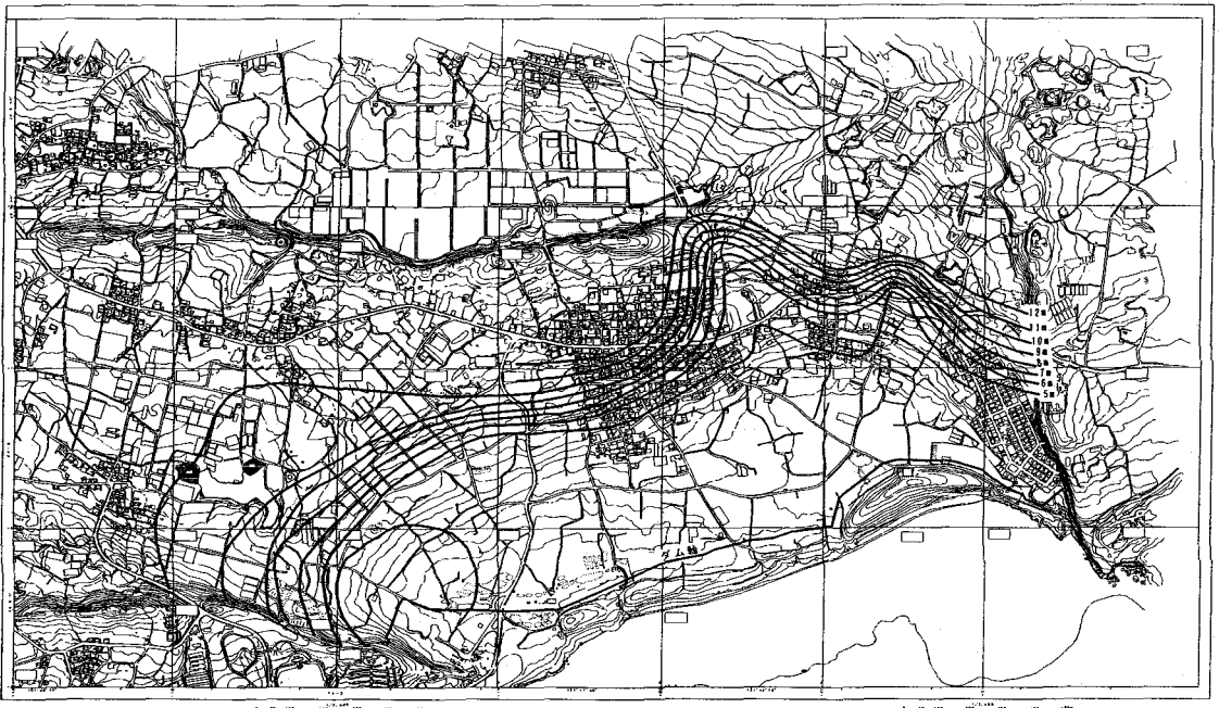
図-12 米須地下ダム地下水コンター図
