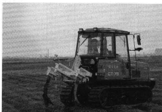
写真-1 弾丸暗渠装着トラクタ
