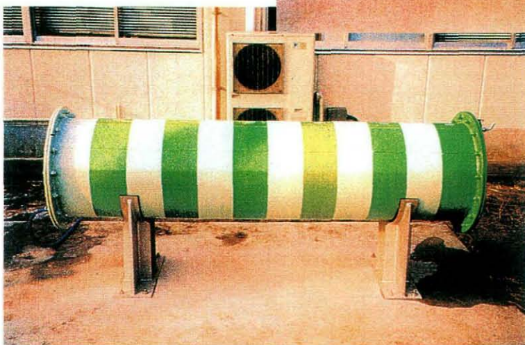
暴露試験体Ⅱ設置状況
