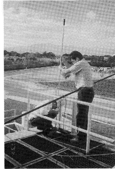
写真一 4 3次元流速計による測定風景(2) (写真中の二人が持っているポールの先端に流速センサーがあり、センサーを槽内の所定の位置に設定している。)
