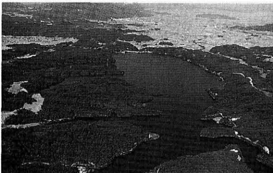
写真－1 白鳳時代に築造された満濃池は、幾多の補修を行い現在の形になっている。（香川県、 H=32m 、 V=15,400千m^3 ）
