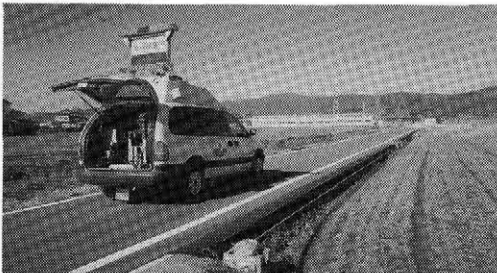
写真—5 FWD試験状況
