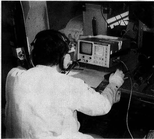
漏水発見器による相関波形の測定
