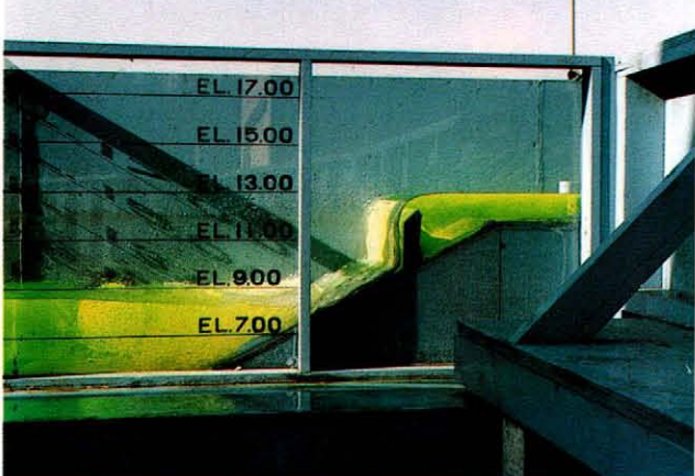
取水量12.495m 3 /sec (計画取水量の1.4倍)
