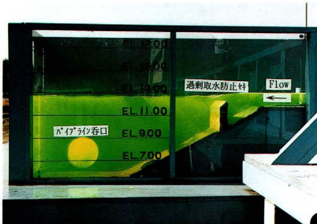
取水量8.840m 3 /sec (計画取水量を取水)
