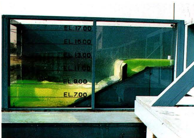
取水量11.256m 3 /sec (計画取水量の1.3倍)
