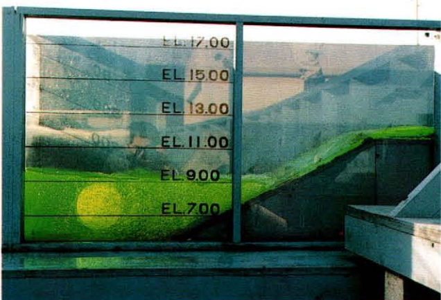
取水量20.864m 3 /sec (計画取水量の2.4倍)
