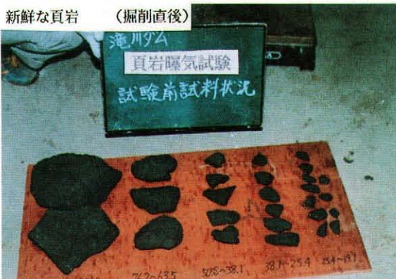
滝川ダム頁岩曝気試験 (掘削直後)
