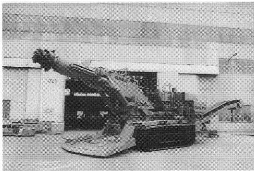
写真一三 トンネル掘進機
