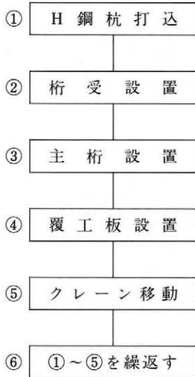
図-8 仮設栈橋施工フロー
