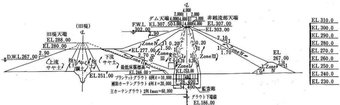
図-4 堤体標準断面図
