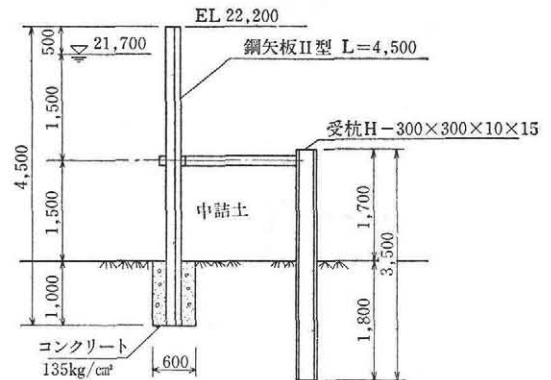
図-6 仮締切工の断面
