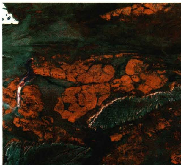
第119図 比演算による画像 BAND4/BAND5：青、BAND5/BAND6：緑 BAND6/BAND7：赤による合成画像
