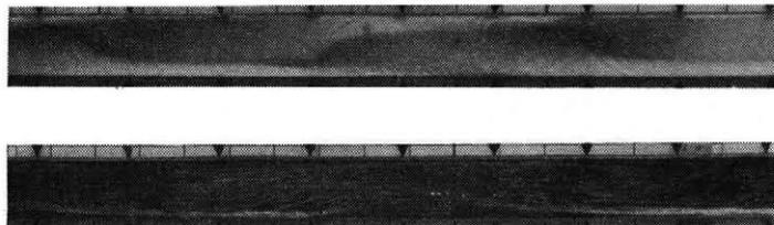
写真-2 実験水路の砂レキ堆と表面流跡線
