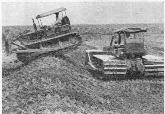
写真—7・6 NTK 5 S S型超湿地ブルドーザによる畦畔転圧
