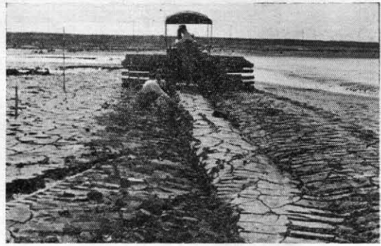
写真—7・5 NTK 4 S S型実験車による走行試験
