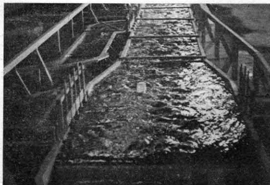
写真-1 三ヶ分水工付近の模型の状態 （原設計案型に対する実験中の流況）
