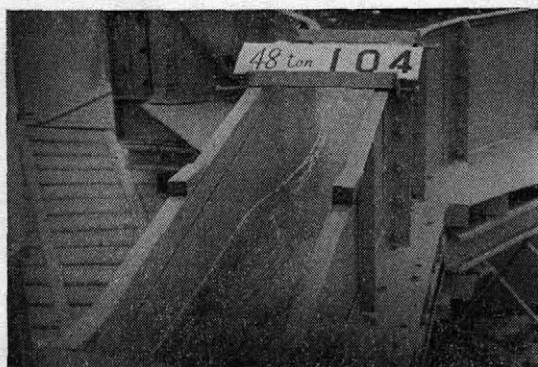
写真一 5 取付水路上流端, 48.t/s
